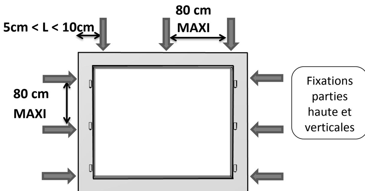
Coffre volet roulant : les fixations sont doublées au niveau de la traverse haute.
