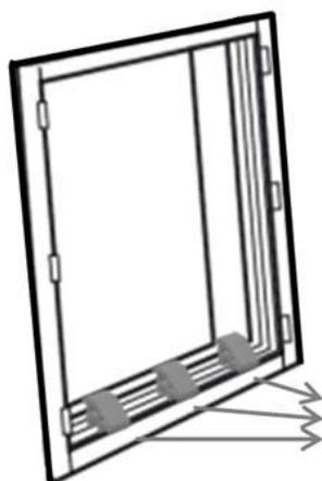
Retirez les cales de transport positionnées dans la rainure du dormant.
