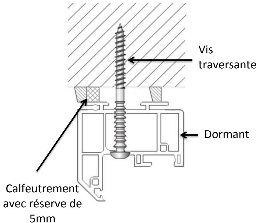
1. Stopper le vissage au niveau du clipage de la paroi PVC sous la tête de la vis (Bruit Clac).
