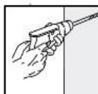
5. Percez la maçonnerie au niveau des repérages.
