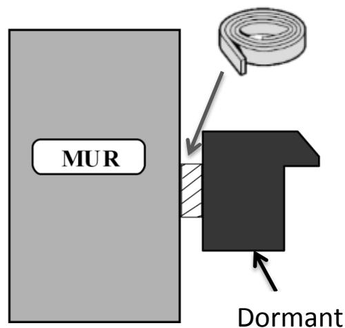
Pour un **fond de joint** : l'insérer entre la maçonnerie et la menuiserie une fois fixée.
