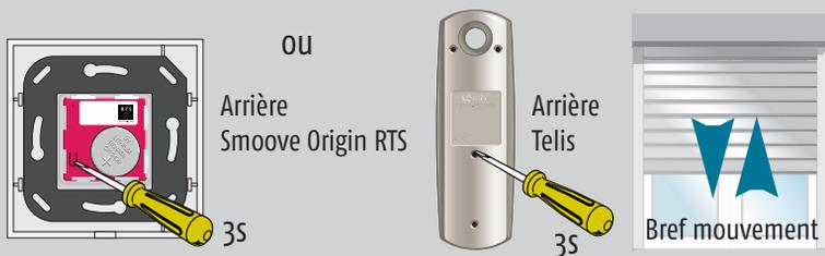
Prendre l'émetteur à supprimer et appuyer sur le bouton de programmation situé à l'arrière.
