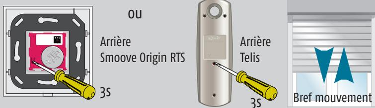
Prendre l'émetteur à ajouter et appuyer sur le bouton de programmation situé à l'arrière.
