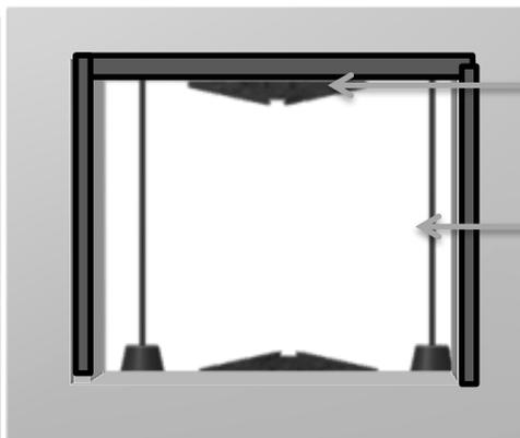
**Tolérance maçonnerie: 3mm/m avec max 10mm**
