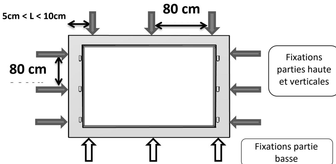
Cas d'un coffre à volet roulant : les fixations sont doublées au niveau de la traverse haute.
