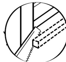
Si l'appui de l'ancienne fenêtre dépasse à l'intérieur, recoupez-le.
