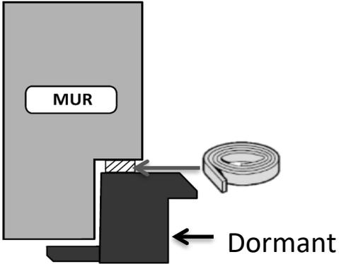
Pour un **fond de joint** : l'insérer entre la maçonnerie et la menuiserie une fois fixée.
