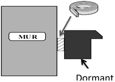
Pour un **fond de joint** : l'insérer entre la maçonnerie et la menuiserie une fois fixée.
