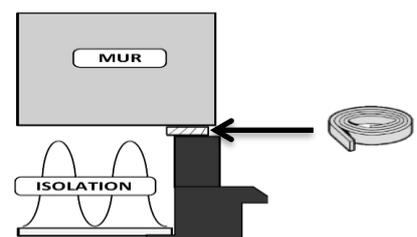
Pour un **fond de joint** : l'insérer entre la maçonnerie et la menuiserie une fois fixée.
