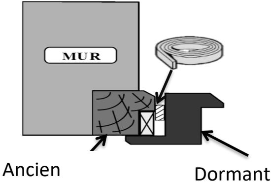
Pour un **fond de joint** : l'insérer entre l'ancien bâti et la menuiserie une fois fixée.
