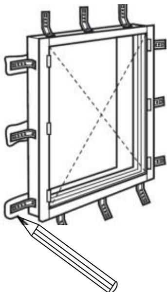
1. Plaquez et centrez la menuiserie contre la maçonnerie et maintenez-la avec deux serre-joints.
