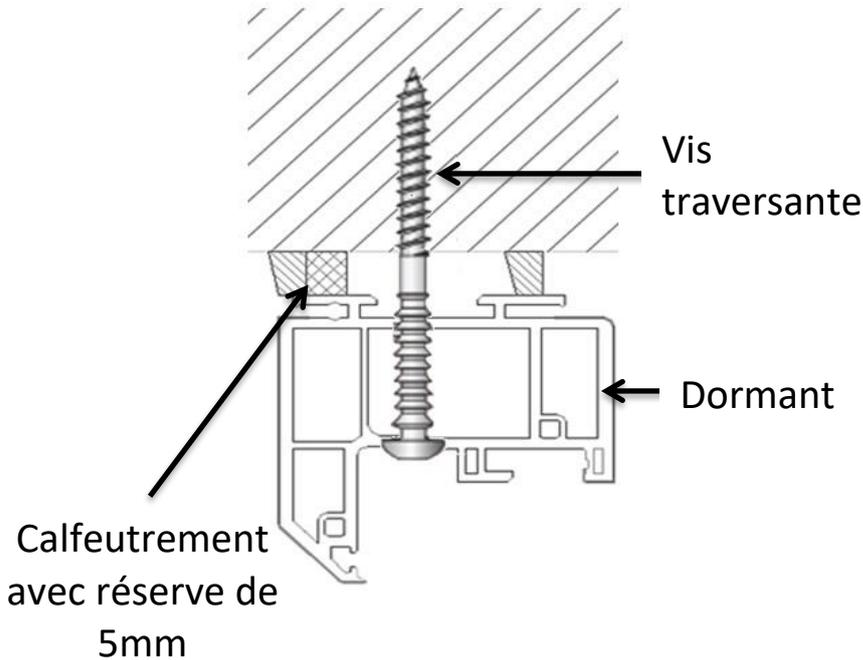
3. Stopper le vissage au niveau du clipage de la paroi PVC sous la tête de la vis (Bruit Clac).
