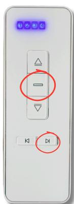
À l'aide des touches gauche et droite, positionnez-vous de façon à ce que le canal 1, 2, 3 et 4 soient allumés simultanément.
