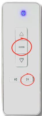
Positionnez-vous sur le canal sur lequel vous souhaitez bloquer la télécommande, par exemple, ici, le canal 3 (pour que seuls les canaux 1, 2 et 3 soient en fonction).
